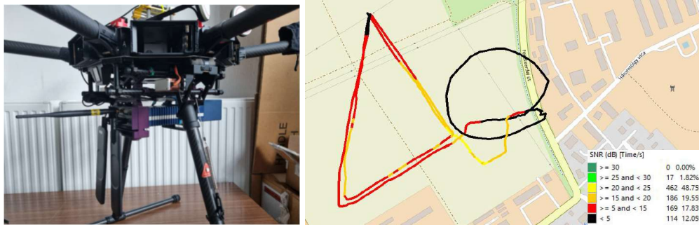
14. ábra UAV alapú Drive-test test-setup egyedi felfogató szerkezettel és az SNR mérés eredménye [25]
